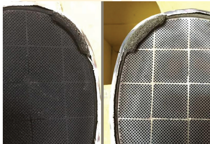
Filtru de particule diesel înainte și după curățare
